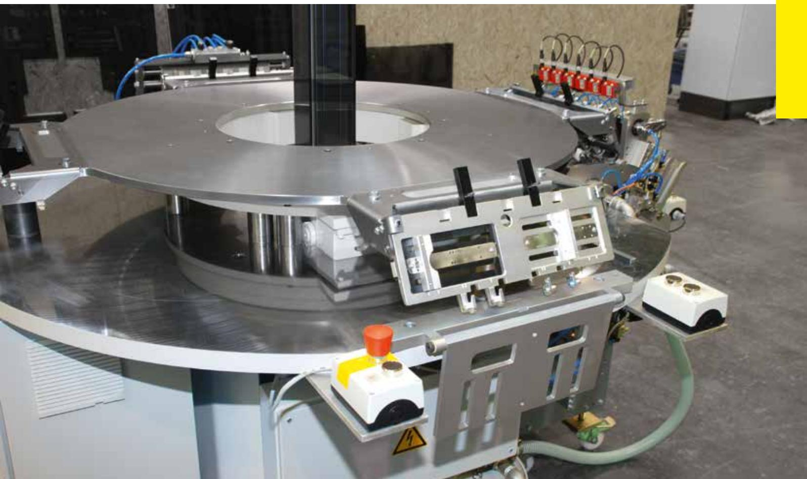
A empresa Kugler-Womako fabrica máquinas para o processamento e impressão e para a indústria de artigos de papelaria. Uma novidade no setor da papelaria: ao invés dos sistemas de transferência linear comuns, é utilizado o anel indexador TR 750.
