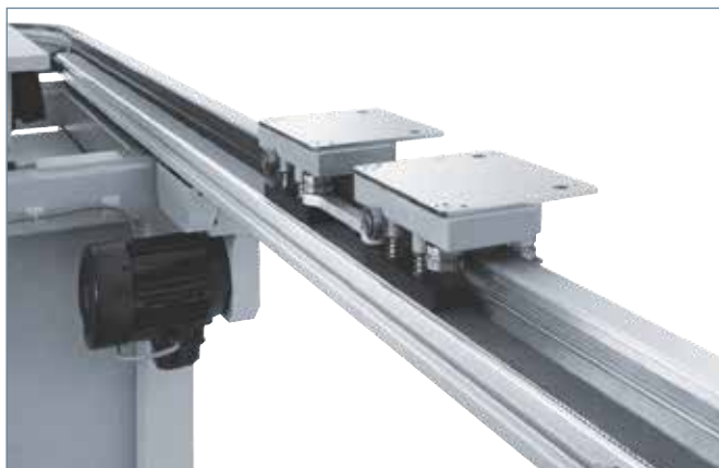
Seção da correia com correia dentada de transporte
