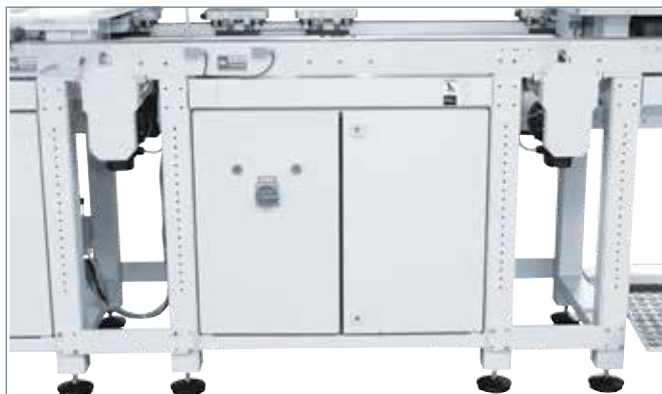
Armário elétrico integrado no quadro básico
