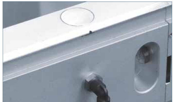
Ponto de lubrificação no trilho de guia
