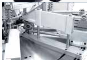
Módulo de elevação
