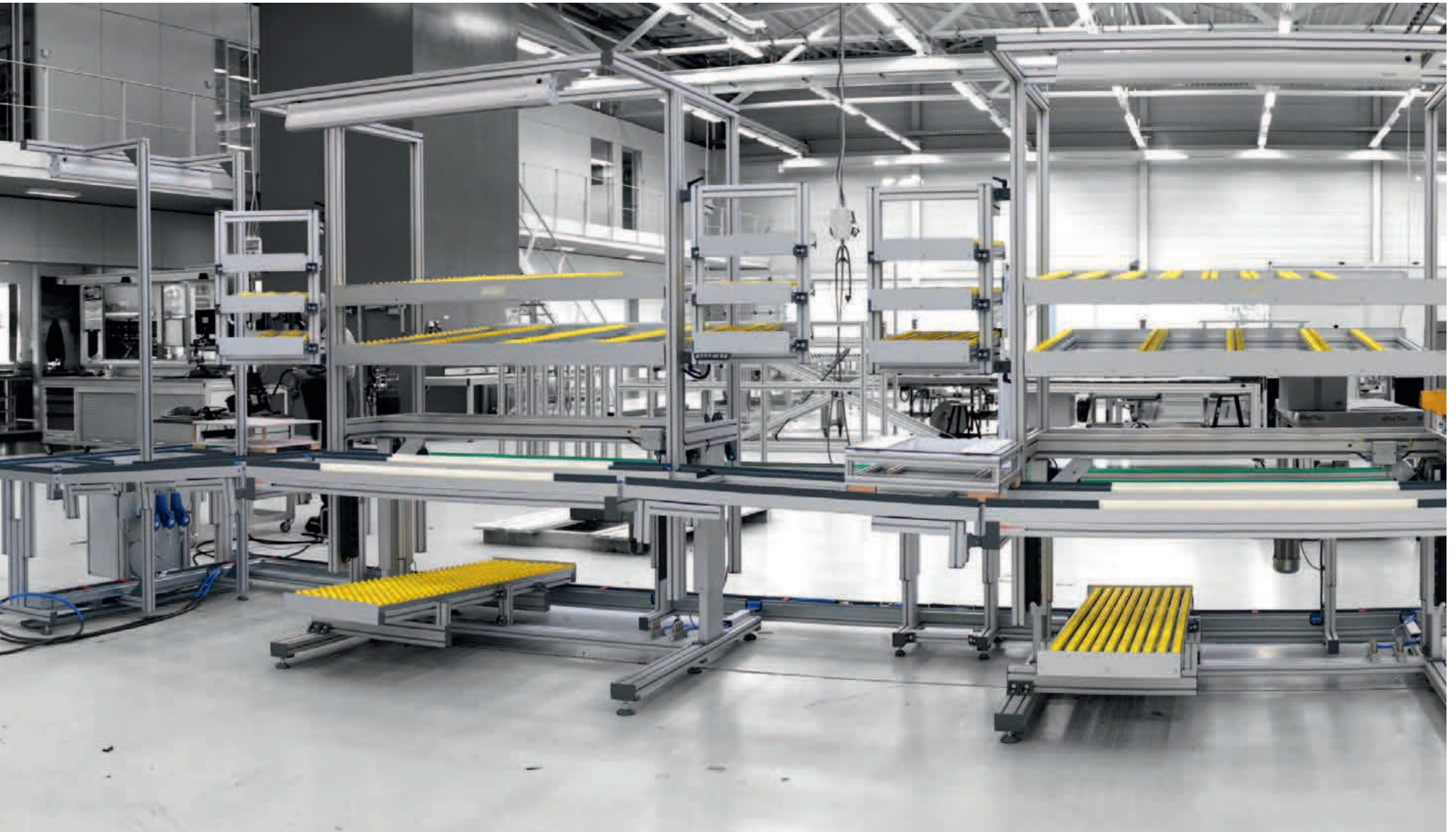
Montagelinie mit Materialbereitstellung und Werkstückträgersystem | Assembly line with material provision and tooling system | Ligne d'assemblage | Línea de ensamblado
